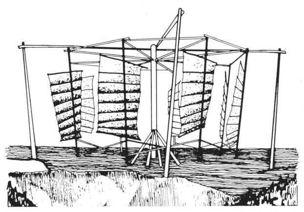
Fig. 2: Ancien moulin à vent chinois à axe vertical, illustration de l'énergie éolienne il y a quelque deux mille ans.
