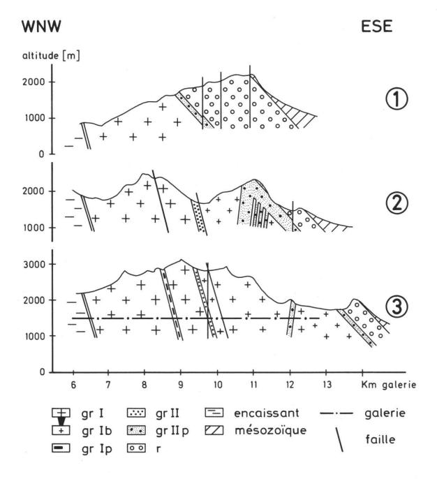
Fig. 3: Profils transverses dans les granitoïdes du Mont Blanc situés en Suisse. Leur situation est indiquée dans la fig. 2b. La largeur des filons est exagérée pour permettre de les distinguer.
