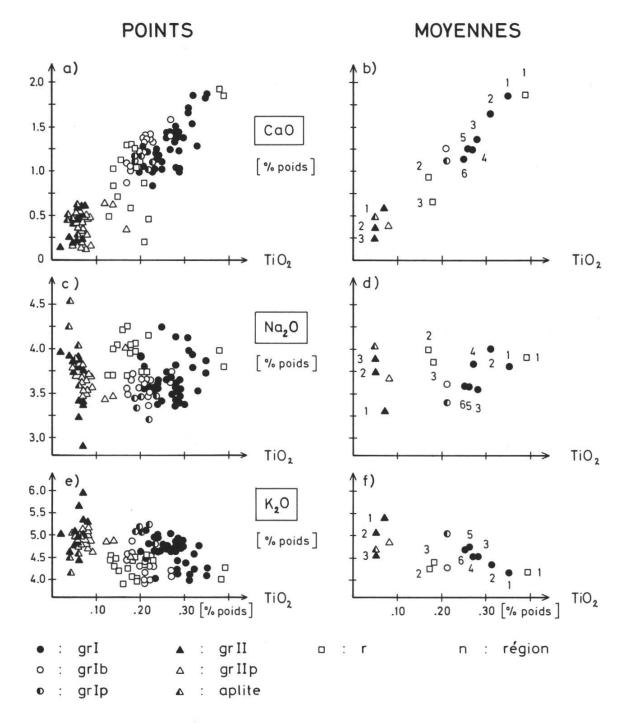
Fig. 7: Variations des cations discriminants des feldspaths, CaO, Na<sub>2</sub>O et K<sub>2</sub>O, en fonction de TiO<sub>2</sub>. Gauche: tous les échantillons. Droite: moyennes régionales pour les roches possédant un trend géographique (gr I, gr II, r) et globales pour les autres (gr Ib, gr Ip, gr IIp, aplites). Régions: comme fig. 6.
