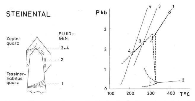
Fig. 4: Zepterquarzwachstum. Infolge brüsker Klufterweiterung, Druckgefälle und Fluidentmischung wird die gasreiche, emulsionsartige Phase an Kieselsäure übersättigt: es kristallisiert der Zepterquarz.
