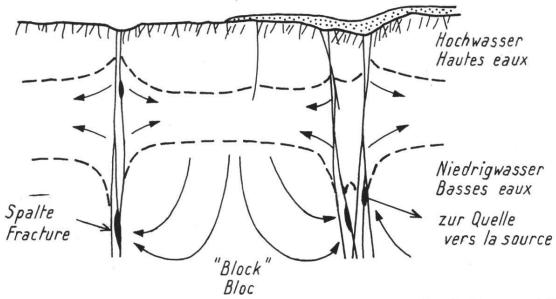
Fig. 5: Schéma du fonctionnement des aquifères calcaires (d'après BURGER, 1979).
