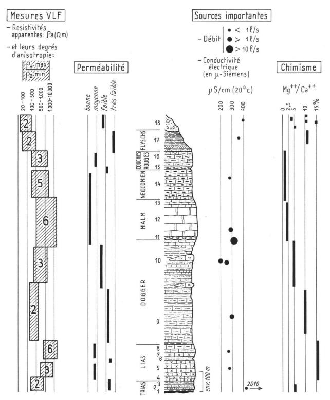
Fig. 2: Lithostratigraphie et caractéristiques physiques des formations géologiques du massif du Vanil Noir. Paramètres physico-chimiques des eaux. Pour la numérotation de la colonne lithostratigraphique, voir dans le texte. Les valeurs du degré d'anisotropie de la résistivité apparente VLF (grands chiffres dans les plages hachurées) sont des valeurs maximum possibles.
