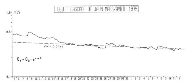
Fig. 12: Analyse d'une courbe de tarissement de la Cascade de Jaun.
