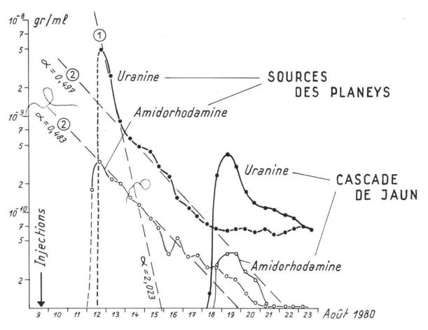
Fig. 15: Courbes de restitution des traceurs fluorescents. (Pour le coefficient  $\alpha$ , voir figure 12).
