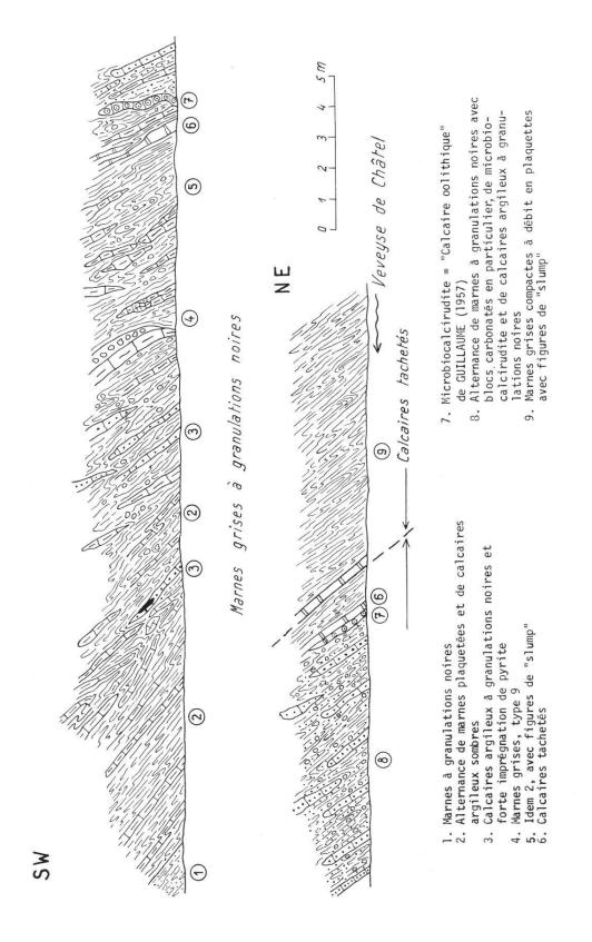
Coupe schématique de la partie supérieure des marnes grises à granulations noires et base des calcaires tachetés à niveaux siliceux dans la Veveyse de Châtel (coord. 560.270/153.180) 21:
