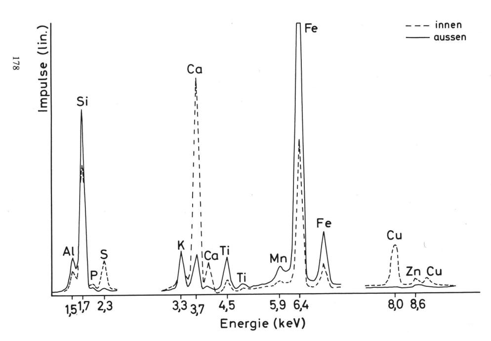
Abb. 3: Energiedispersive Röntgenspektren der Außen- und Innenseite des Schmelztiegels. Die Innenseite ist deutlich Ca-, Cu-, S- und Zn-reicher als die Außenseite.
