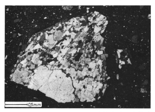
Abb. 3: Schliffbild der Magerung des Scherbentyps 3d (Nr. 40, N+). Die Matrix erscheint wieder schwarz, in ihr liegen viele graue, kleine Quarze. Das Granit-Fragment ist eckig und besteht aus einem Haufen von kleinkörnigem Pflasterquarz, einem größeren, perthitischen Kalifeldspat (unten) und dazwischen gelagerten Glimmern.
