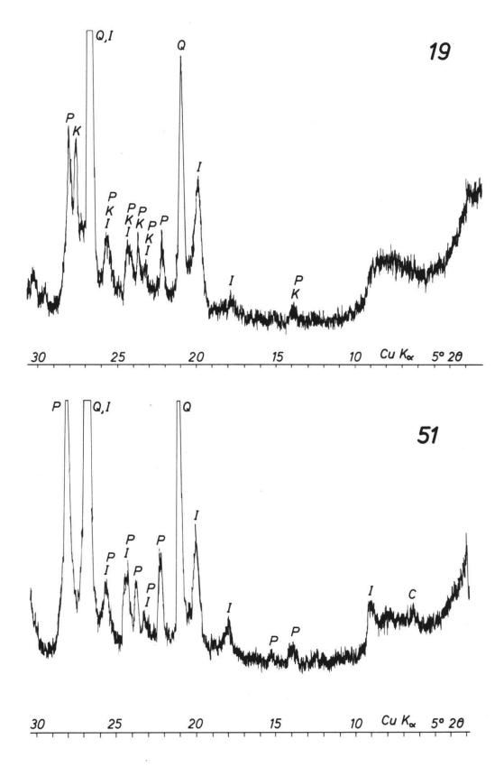
Abb. 6: Typische Röntgen-Diffraktogramme der Scherben; oben die Probe Nr. 19, unten die Nr. 51. Man erkennt gut die einzelnen Peaks von Chlorit (C), Illit (I), Kalifeldspat (K), Plagioklas (P) und Quarz (Q). Der breite Buckel zwischen 5-10° 2 θ (Nr. 19) ist durch Illit bzw. schlecht geordneten Chlorit bedingt.
