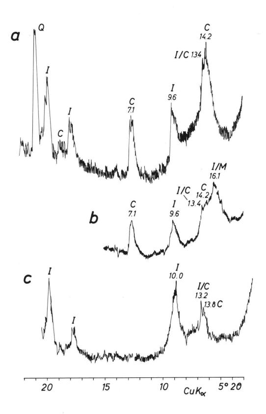
Abb. 7: Röntgendiffraktogramm des Scherbens Nr. 13. Orientierte Aufnahmen:
