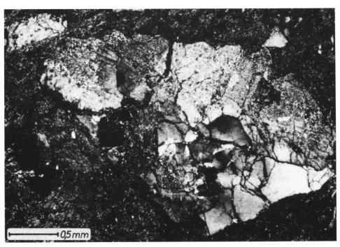
Abb. 4: Schliff Nr. 19, N+. Zu erkennen ist die extrem fette Matrix, in der das Granit-Fragment liegt; dieses besteht aus zerbrochenem, z.T. undulös auslöschendem Quarz und serizitisiertem Plagioklas bzw. Kalifeldspat.
