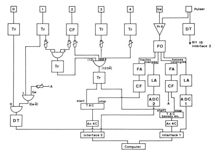
Figur 2: Blockschema der elektronischen Schaltung.
