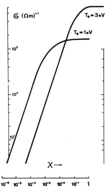
Fig. 11: Elektrische Leitfähigkeit als Funktion des Ionisationsgrades x.
