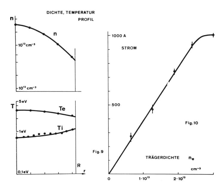
Fig. 9: Trägerdichte und Elektronentemperatur aus den Messungen der Doppelsonde. Ionentemperatur aus dem Linienverhältnis der ArII-Linien (nach Lösung des Abel'schen Integrals).
