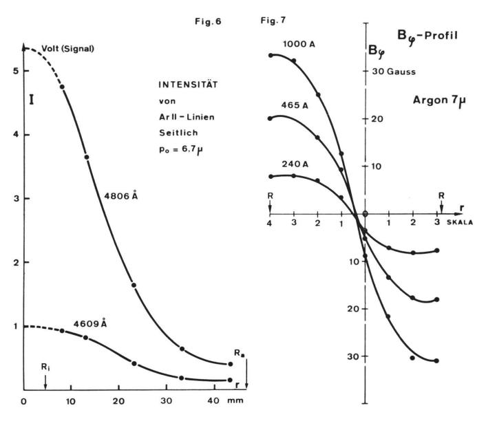
Fig. 6: Intensitätsprofil der ArII-Linien 4609Å, 4806Å.
