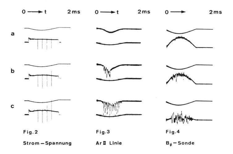
Fig. 2: Strom-Spannung, bei verschiedenem Druck: a) 7.6 $\mu$ , b) 4 $\mu$ , c) 2 $\mu$ .
