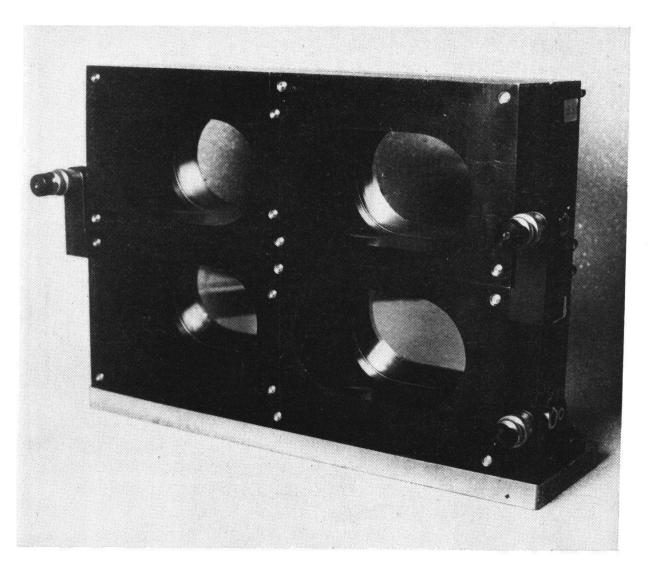
Fig. 8: Bloc mosaïque permettant de courber 4 cristaux. Chacun des éléments peut être orienté avec une précision de 1 sec. d'arc par rapport au bloc de référence (l'un des quatre) au moyen d'une vis micrométrique.
