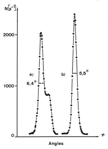
Fig. 4 · Réflexes observés avec un cristal de quartz de 0,25 × 10,5 × 10,5 cm³, courbé dans un bloc ayant une fenêtre de 42 cm² a) avant le traitement, b) après le traitement thermique.
