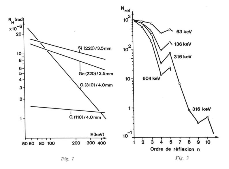
Fig. 1: Réflectivité intégrale en premier ordre observée en fonction de l'énergie pour les plans (220) du silicium et du germanium et (310) et (110) du quartz. Les résultats sont corrigés pour l'absorption. Tandis que la source avait une largeur apparente de 2 sec d'arc, les largeurs des réflexes étaient de 7,5 sec pour Ge(220), 14,5 sec pour Si(220), 3,0 sec pour Q(110) et 12,5 sec pour Q(310) (BEER, 1974).
