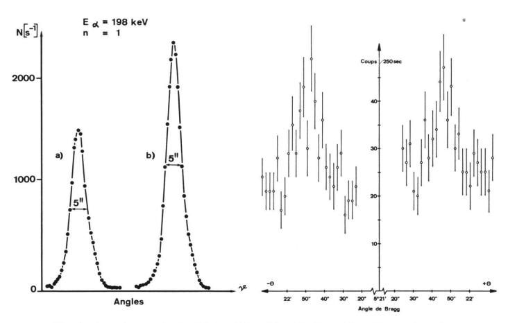
Fig. 9: Accroissement de l'intensité d'un réflexe d'une lame de quartz soumise à l'action d'un champ électrique: a) réflexe avec champ nul, b) réflexe avec un champ de 2000 V/mm.
