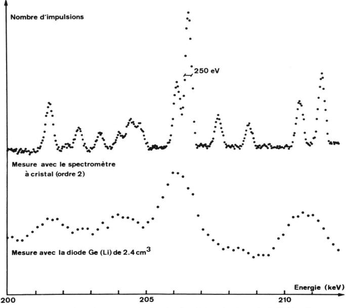
Fig. 5: Portion du spectre de la réaction Ir(n, γ) observée à l'aide d'une diode Ge(Li) de 2,4 cm³ et avec le spectromètre à cristal de Fribourg (RAEMY et al., 1975).
