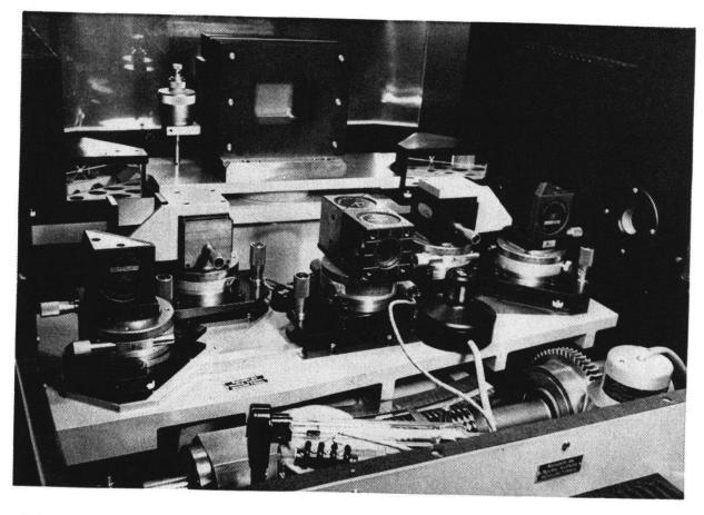
Fig. 3: Vue de l'interféromètre à laser monté sur le spectromètre à cristal incurvé de Fribourg (Schwitz et Kern, 1974).
