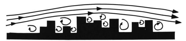
Fig. 2: Représentation schématique de l'écoulement d'une masse d'air pardessus une zone bâtie. La rugosité de la surface provoque des turbulences locales.
