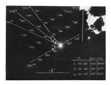
Abb. 3 Als Fayalit indiziertes FB-Beugungsbild aus dem Scherben des bei  $1200^{\circ}$ C gebrannten V 10. Aufnahme Nr. 394/74 und 396/74. Strichbreite 1  $\mu$ m.
