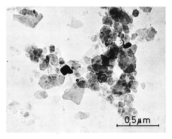
Abb. 1 Fehlgeordnete Kaolinite (sechseckige Umrisse) und Illite (unregelmäßige Umrisse) im Roh-Ton S II TEM-Aufnahme Nr. 856/73. Strichbreite 0,5 μm.
