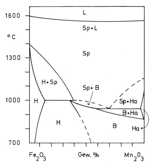
Abb. 3 Phasendiagramm des Systems  $Fe_2O_3 - Mn_2O_3$  nach A. Muan und Sh. Somyia (1962). B = Bixbyit, Ha = Hausmannit,  $H = H\ddot{a}matit$ , L = Schmelze, Sp = Spinell.
