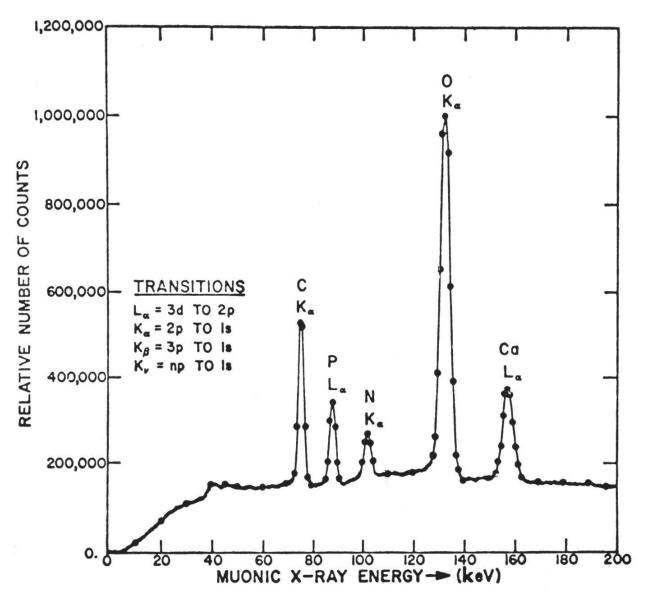
Figur 1: Niederenergetische  $\mu$ -Röntgenlinien von menschlichem Knochen. Das computersimulierte Spektrum basiert auf 1 cm Absorption im Knochen, 5 cm Absorption im Gewebe und einem 30 ccm Ge(Li)  $\gamma$ -Detektor.
