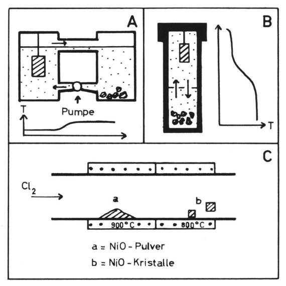
Fig. 4: Kristallzucht aus flüssiger und gasförmiger Lösung.
