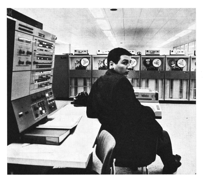
Système IBM 360 où l'unité centrale, le pupitre de commande et des unités de bandes magnétiques sont représentés.
