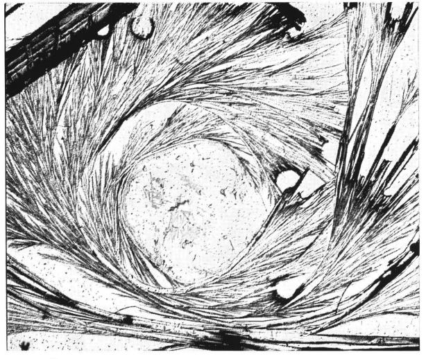
Abb. 6 Übergang von Fächerwachstum zur Einwicklung (Hohlformenbildung) beim Rekristallisationsversuch einer BKB-Mischung. Man beachte auch den kontinuierlich gekrümmten «Faden», hell im Foto, U-förmig, unterhalb des kristallfreien Eiweißhofes. Bildbreite ca. 20 mm.
