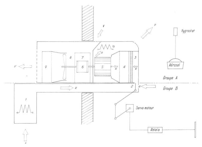
Abb. 8 Schema der Klimaanlage. Frigidaire-Bürogerät (groupe A) kombiniert mit direkt gesteuertem Luftkanal (groupe B).
