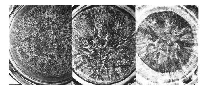
Abb. 21 Empfindlicher Bereich der  $CuCl_2$ -Kristallisation für konstanten Gelatinezusatz (0,5 ml) und wechselnde Mengen  $CuCl_2$  (20 %) ad 10 ml Wasser.
