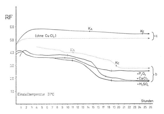
Abb. 15 Einfluß von Feuchtung oder Trockenmitteln auf die Kupferchlorid-kristallisation; am Beispiel einer Einstelltemperatur von 31°C.
