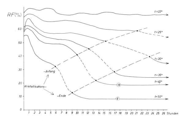
Abb. 14 Kristallisationsdauer und Gang der Feuchte im Trockenschrank bei verschiedenen Einstelltemperaturen (22°C . . . 50°C).
