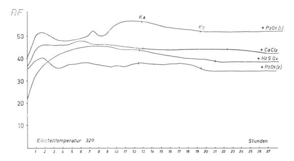
Abb. 16 Einfluß von Feuchtung mit Trockenmittel (P<sub>2</sub>O<sub>5</sub>, CaCl<sub>2</sub>, H<sub>2</sub>SO<sub>4</sub>) kombiniert, Einstelltemperatur 32°C.
