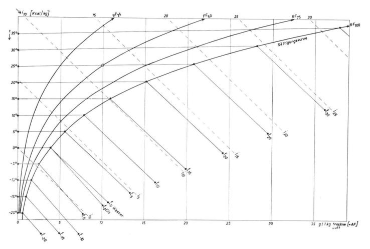
Abb. 13 Vereinfachtes Mollier-Diagramm für feuchte Luft.
