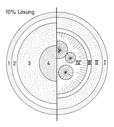
Abb. 20 Zentrierung im Wachstumsfeld des zusatzfreien CuCl<sub>2</sub>, kristallisiert aus 10 % iger CuCl<sub>2</sub>-Lösung.
