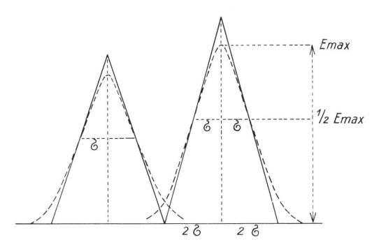
Abb.~I: Gauss'sche Verteilungskurven von 2 benachbarten Chromatogrammfraktionen mit eingezeichneten gleichflächigen Dreiecken. Abszisse: Fraktionsvolumen; Ordinate: Extinktion:  $E = \log \frac{Io}{I}$
