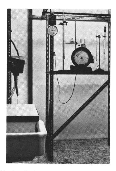
Fig. 3. Le laboratoire : La photo nous montre l'emplacement « idéal » qui est défini par la table encastrée par des rails Dexion. Cette table a une surface de 0.6 m². Sur cette table se trouve, à droite du thermohygrographe, le thermomètre à contact. — A gauche de la photo, en arrière de l'évier, on reconnait le bassin d'alimentation en eau de l'aérosol.
