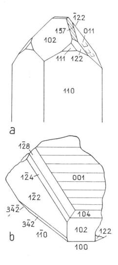
Fig. 23. Anglesit. a) Müsen (Nr. 5). Die schmalen Flächen 157 sind parallel zur Schnittkante mit 122 gestreift. Auf 011 Wachstumsaufsätze mit 021 und 122 als Begrenzungselementen. b) Monteponi (Ph. III). Kopfbild einer Ecke am obern Kristallende mit großer, gestreifter Basis.
