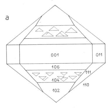
Fig. 22. Baryt von Felsöbánya. a) Nr. 3: Auf den breiten 104-Flächen Wachstumsdreiecke mit den Kanten [010] und [144]. b) Nr. 7: Das alternierende Auftreten von 110 und 110 erzeugt die gerippte Scheinfläche 100.
