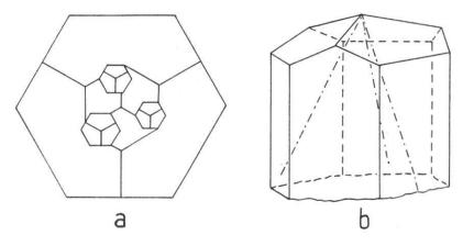
Fig. 6. Calcit. Schneeberg (Nr. 20). a) Die Kristallspitze ist durch eine Vertiefung ersetzt, aus der kleine Calcitindividuen des gleichen Habitus herauswachsen. b) Prismatischer, stumpf abgeschlossener Kristall mit deutlichem 4041-Kern.
