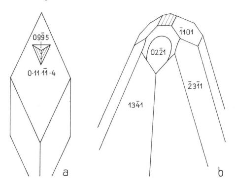
Fig. 8. Calcit. a) Harz (Nr. 42). Auf den Rhomboederflächen 0.11.11.4. Wachstumshügel mit 0995 und 1451. b) Bigrigg (Nr. 127). Von den Endflächen der skalenoedrischen Kristalle ist 0221 oben und seitlich gerundet.
