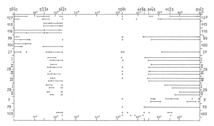
Fig. 12. Calcit. Goniometrische Ausmessung der Zone 0112: 2110. Die links und rechts vermerkten Nummern verweisen auf die im Text genannten Fundorte. Durch die längern oder kürzern Geraden sind die kontinuierlichen Reflexbänder versinnbildet: Kreuzchen und kurze vertikale Striche entsprechen Einzelbildern bzw. hellen Stellen oder Enden der Reflexbänder.
