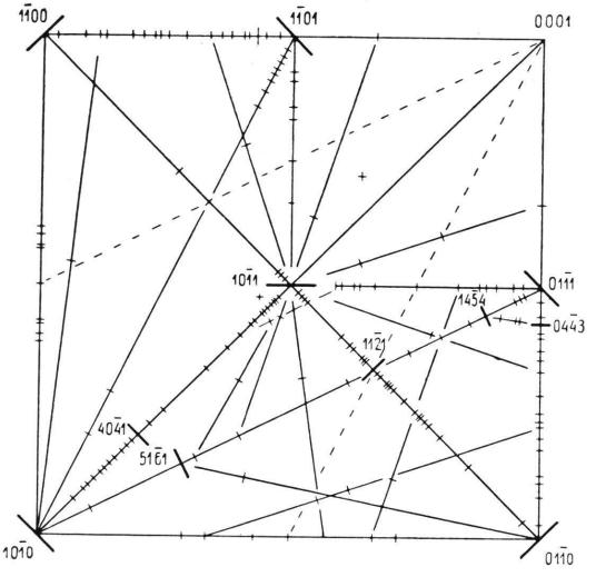
$Fig.\ 4^{\rm a}$ . Formen und Zonen der italienischen Quarze. Schematische Darstellung in zwei gleichschenklig-rechtwinkligen Dreiecken.
