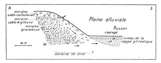
Fig. 2. — Coupe géologique schématisée du versant morainique droit de la Plaine du Russon, au S-W de Vuadens, montrant les conditions hydrologiques souterraines.
