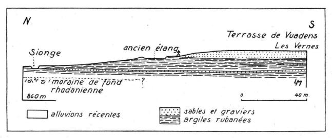
Fig. 3. — Profil du talus d'érosion de la Terrasse de Vuadens au S de la Faucillière.
