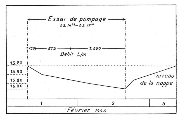
Fig. 6. — Influence d'un essai de pompage sur le niveau de la nappe.
