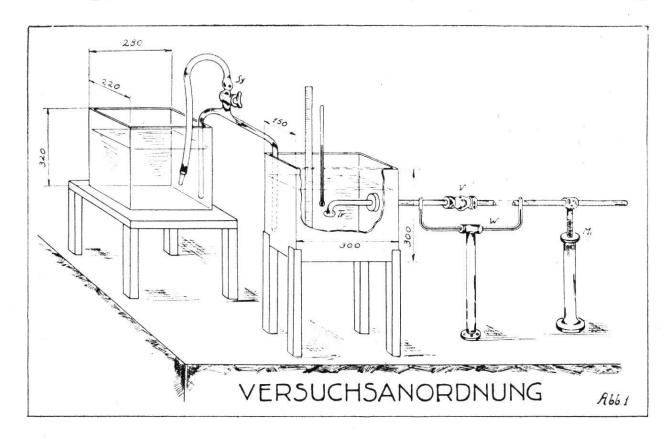
von 105,25 cm. Jede der beiden ersteren konnte mit der letzterwähnten dritten Röhre Glas an Glas und Lumen auf Lumen dicht anschliessend verbunden werden. Die Verbindung geschah zunächst durch Umwickeln mit einem Kunstharzstreifen «Luzida» und sodann durch Verschraubung mit einem in der Industrie oft gebrauchten Verbindungsstück, wie es in der Abbildung 1 (V) vergrössert gezeigt ist.
