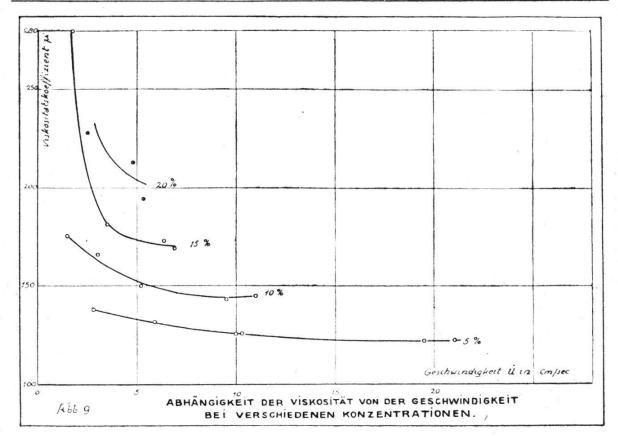
Versuche zur Bestimmung des Einflusses der Geschwindigkeit auf den Wert des Viskositätskoeffizienten. Geschwindigkeit 4.
