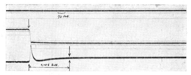
Abb. 8. Experimentelle Bestimmung der Dauer der Initialphase t aus der Staudruckkurve. H=137 cm.  $\mu=0,7472,\ \varsigma=1,211,\ \text{Temperatur}=16,5^{\circ},\ l=505,2$  cm., r=1,10 cm., v=63,15 cm. t=1,105 Sek.
