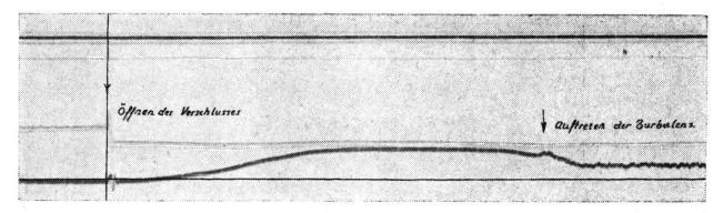
Abb. 13. Druckkurven bei einer Strömung mit der Reynold'schen Zahl Z ≤ 1900.
