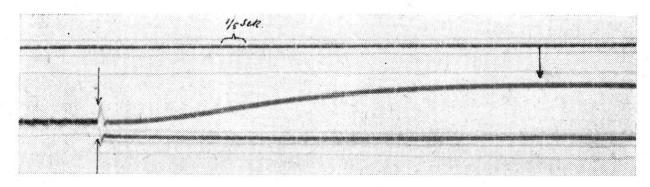
Abb. 9. Experimentelle Bestimmung der Initialphase wie bei Abb. 8  $H=69.5,\,\mu=0.1954,\,\varrho=1.1632,\,{\rm Temp.}=15.0^{\rm o},\,l=505.2\,{\rm cm.},\,r=1.1\,{\rm cm.}$   $v=101.7\,{\rm cm.},\,t=3.5\,{\rm Sek.}$
