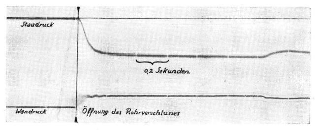
Abb. 6a. Verlauf des statischen Druckes und des Staudruckes. Als Versuchsflüssigkeit diente Wasser. Die Druckhöhe H betrug 70 cm. Beide Kurven zeigen Druckänderungen ausserhalb der Initialphase. Sie beruhten auf Wirbelbildungen an der Rohrmündung, die Aenderungen des Ausflusstrahles zur Folge hatten.
