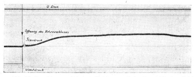
Abb. 12. Druckkurven bei einer Strömung mit der Reynold'schen Zahl Z = 1260 (Uebergangsform). Die Staudruckkurve zeigt, dass Laminärströmung verhanden ist, eine Gleichgewichtslage aber nicht erreicht wird.
