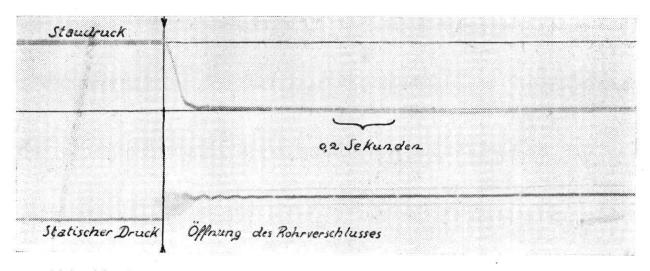
Abb. 6b. Gleicher Versuch wie Abb. 6a. Als Flüssigkeit wurde hier Glycerin mit der Dichte S=1,19 benützt. Die unregelmässigen Druckschwankungen ausserhalb der Initialphase sind verschwunden.
