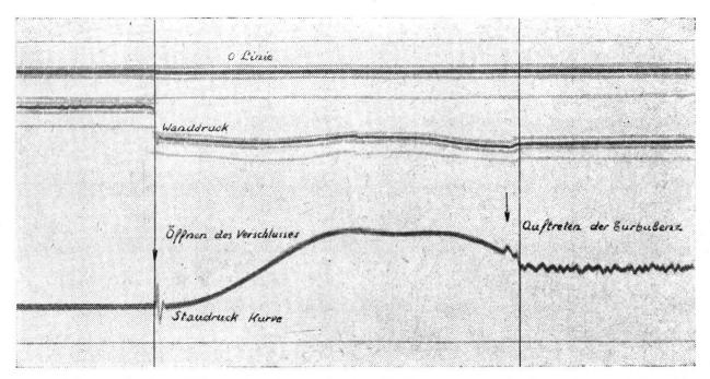
Abb. 14 Druckkurven bei einer Strömung mit der Reynold'schen Zahl Z ≤ 2000.
