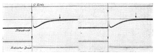
Abb. 11. Bebliebig ausgewählte Kurven aus einer Serie von 20 Versuchen mit einer Stahlröhre von 276 cm. Länge und 1,6 cm. Durchmesser. Das Mündungsstück war trompetenförmig gebaut. Die Druckkurven wurden in einem Abstande von 130 cm. vom Röhrenanfang ab aufgenommen. Die Öffnung des Rohres geschah durch plötzliches Entfernen des zum Verschlusse benützten Fingers. Die Druckhöhe schwankte zwischen 136 und 138 cm., die Temperatur zwischen 13,5 und 14,5° C.
