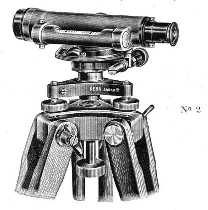
Ce petit instrument de nivellement porte comme complément utile un cercle horizontal du diamètre 7cm, division 360° ou 400°. A l'aide d'un index à loupe on peut lire les  $^{1}/_{10}$ °. Grossissement de la lunette = 19 fois. La sensibilité du niveau est de 40 ″ pour 2 mm.
