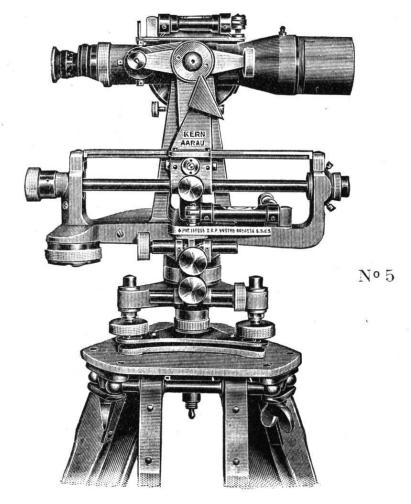
C'est un théodolite autoréducteur qu'on utilise avec une mire divisée en centimètres et tenue verticalement à l'extrémité d'une ligne à mesurer. L'instrument donne, même en terrain accidenté, directement la distance horizontale, sans aucun calcul de réduction. La construction de ce tachéomètre est basée sur le principe du tachéomètre-réducteur bien connu de l'ingénieur français Sanguet, ; toutefois la maison Kern & Cie y a apporté de grandes améliorations.
