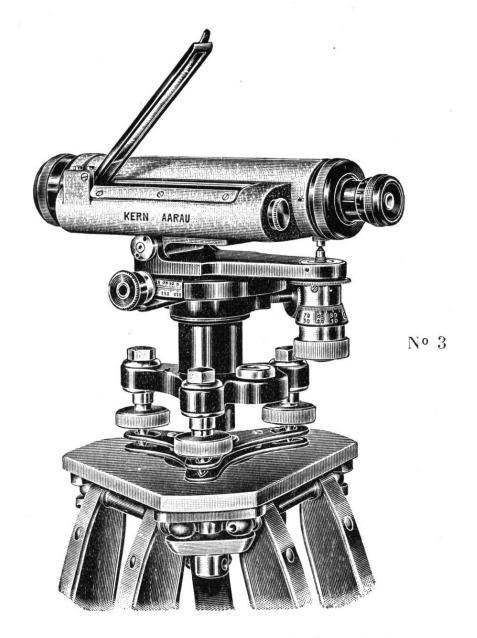
est de  $\pm$  4 mm. La lunette porte un réticule gravé sur verre avec traits stadimétriques donnant les distances avec une précision d'environ  $\pm$  15 cm pour 100 m. L'instrument possède une vis de fin calage appelée aussi vis de pourcentage pouvant servir au tracé de pentes et de levers tachéomètriques. L'inclinaison des visées peut être lue sur la vis de pourcentage jusqu'à  $\pm$  15%.
