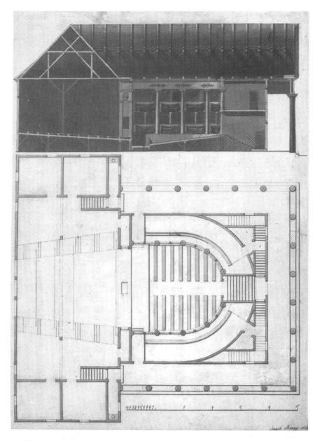
Abb. 2: Joseph de Raemy, Entwurf für ein Theater, Grundriss Parterre und Längsschnitt, 1820. KUBF, LE 4, Nr. 17.
