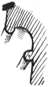
Abb. 5. Profil des Dachgesimses vom Chor.
