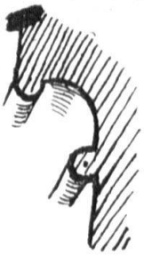
Abb. 5. Profil des Dachgesimses vom Chor.
