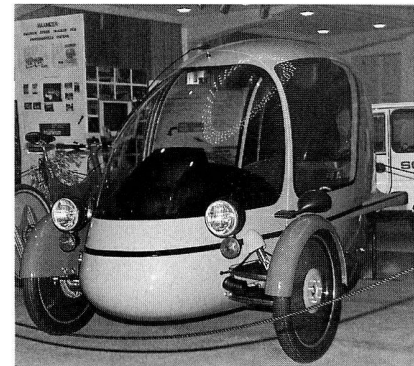
Horlacher-Fahrzeug aus Duroplast-Kunststoffen.
