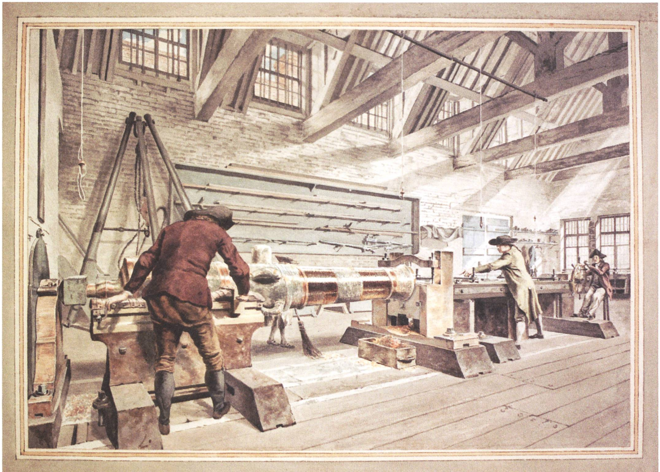
4 Horizontale Bohrmaschine in der Königlichen Stückgiesserei zu Woolwich, Zeichnung von Jan Verbruggen, um 1778.
