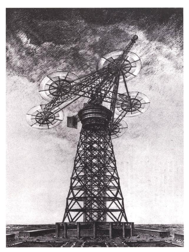
${\bf 1} \ \ {\bf Entwurfszeichnung \ eines \ H\"{o}henwindkraftwerks \ von \ Hermann \ Honnef, 1930er-Jahre.}$
