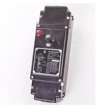
7 Bis in die 1980er-Jahre wurden FI-Schutzschalter installiert, die bei einem Fehlerstrom von über 50 Milliampere abschalteten, da man befürchtete, dass es bei einem niedriger eingestellten Auslösestrom zu häufigen Fehlauslösungen kommt. Der gezeigte Fehlerstrom-Schutzschalter der Firma Schutzapparate-Gesellschaft Paris & Co. von 1950 löst bei einem Fehlerstrom von 1 Ampere aus.
