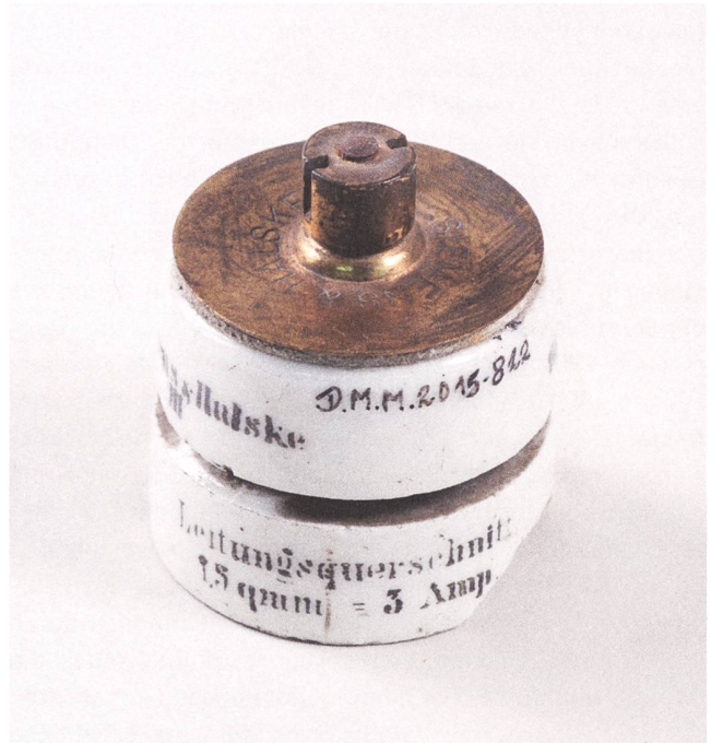
5 Schmelzsicherungen mit Bleidraht, wie diese von Siemens & Halske, wurden bereits Ende des 19. Jahrhunderts eingesetzt, um elektrische Anlagen beispielsweise im Falle eines Kurzschlusses zu schützen. Mit Einführung der (klassischen) Nullung dienten solche Schmelzsicherungen zusätzlich als Schutz des Menschen vor Körperschluss.
