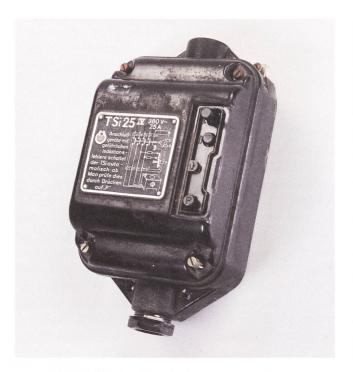
6 FU-Schutzschalter der Firma Schiele Industriewerke um 1960. Vor Einführung der (klassischen) Nullung war bereits die Schutzerdung als Sicherheitsmassnahme gegen zu hohe Berührungsspannung bekannt. Diese stellte sich aber wegen des oft zu hohen Erdungswiderstands als unzuverlässig heraus. Um schutzgeerdete Anlagen sicherer zu machen, wurde nach dem Ersten Weltkrieg der FU-Schutzschalter eingeführt.
