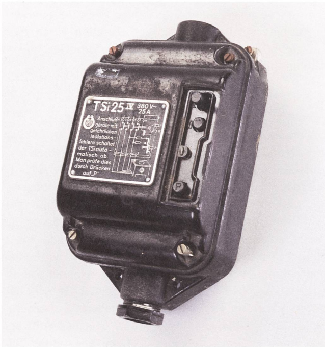
6 FU-Schutzschalter der Firma Schiele Industrierwerke um 1960. Vor Einführung der (klassischen) Nullung war bereits die Schutzerdung als Sicherheitsmassnahme gegen zu hohe Berührungsspannung bekannt. Diese stellte sich aber wegen des oft zu hohen Erdungswiderstands als unzuverlässig heraus. Um schutzgeerdete Anlagen sicherer zu machen, wurde nach dem Ersten Weltkrieg der FU-Schutzschalter eingeführt.
