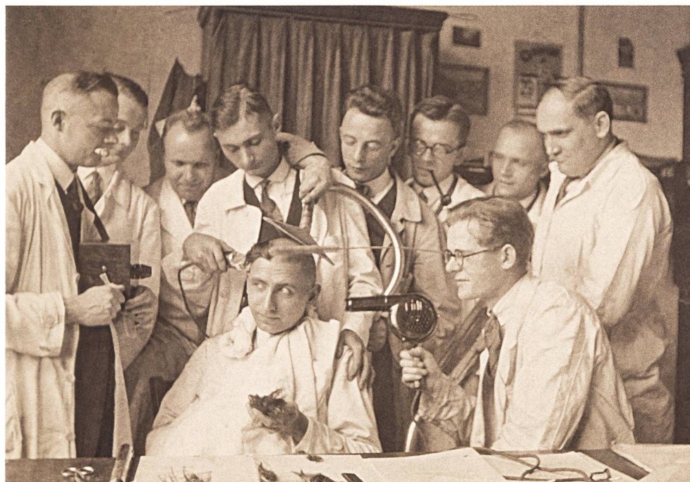
4 In der 1920 geschaffenen VDE-Prüfstelle wurden elektrotechnische Produkte daraufhin geprüft, ob sie die bestehenden VDE-Bestimmungen erfüllen. Dieses sicherlich gestellte Bild zeigt die Prüfung eines Haartrockners.
