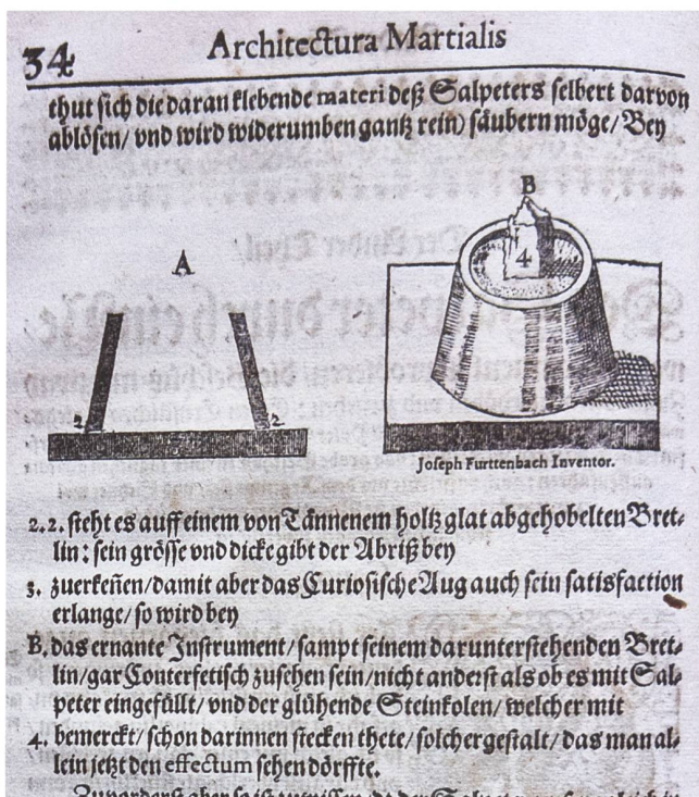
1 Das von Joseph Furtttenbach d. Ä. in seinem Traktat «Architectura Martialis» vorgestellte Instrument diente zur Prüfung der Qualität von Salpeter.
