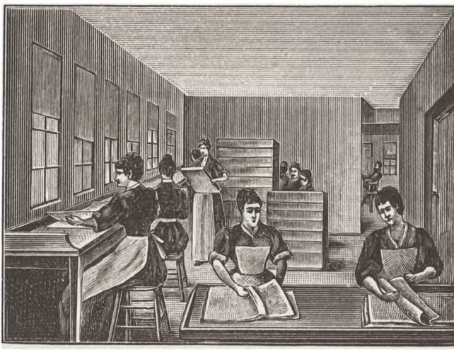
5 Schritte bei der Herstellung von Albumin-Kopierpapier für die Fotografie: Schlagen des Albumins zu Schaum, Tränken des Kopierpapiers mit flüssigem Albumin und Aufhängen zur Trocknung, Satinieren des Albuminpapiers, d.h. Pressen im Kalandr, um eine geschlossene, glänzende, glatte Papieroberfläche zu erhalten, und schliesslich Sortieren und Verpacken des handelsfertigen Papiers.
