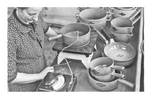
In einer Verkaufsbroschüre von 1940 wird die Qualitätsprüfung beschrieben: «Bei jeder Kochgeschirr-Kategorie werden in Stichproben Abschreckversuche vorgenommen. Auf der elektrischen Kochplatte werden die Töpfe trocken auf 250° erhitzt um darauf sofort unter dem Wasserhahn abgeschreckt zu werden. Dieser Vorgang wird 100 Mal wiederholt und trotzdem darf nachher weder Email abgesplittert sein noch der Topfboden irgendwie Formveränderungen aufweisen.»
