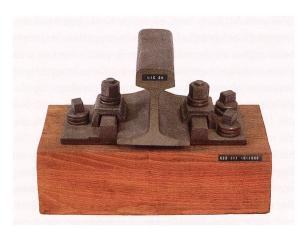
Die nach dem Zweiten Weltkrieg übliche Befestigungsart bei den SBB mit dem U-förmigen Klemmplättchen erlaubt eine geringe Elastizität. Die Federringe sichern einen kontrollierten Anpressdruck und verhindern vor allem ein selbstständiges Lösen der Schrauben.
