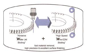
Untersuchte mögliche alternative Verfahren zum Räumen: Wasserstrahlschneiden und Funkenerosion.
