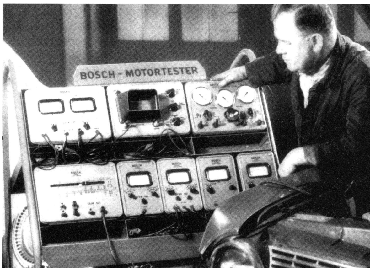
Das Bosch Baukastensystem ermöglichte die flexible Integration einzelner Testgeräte zum Grosstester.
