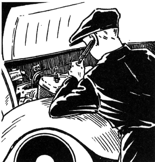
Als einfaches auditives Hilfsmittel diente oftmals ein Schraubenzieher.
