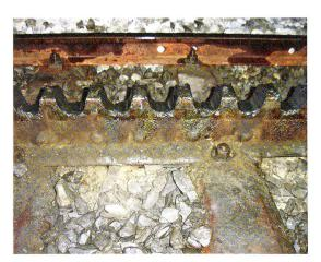
Bei dieser Strub-Zahnstange ist die Zahnflanke zu niedrig bzw. die Zahnräder sind zu klein, um eine gleichförmige Kraftübertragung sicherzustellen. Dies führt zu Deformation der Zahnflanken. Sichtbar ist auch, dass Abnützungsspuren sowohl in den Zahnköpfen als auch im Zahngrund vorhanden sind.
