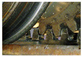
Korrekter Eingriff eines Triebzahnrades in eine moderne Lamellenzahnstange bei der Dolderbahn. Wie vorgeschrieben, befindet sich mehr als ein Zahn gleichzeitig in Eingriff.
