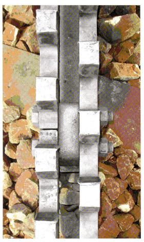
Bei Abt-Zahnstangen wurden wegen stärkerer Triebfahrzeuge die Zahnstangenlamellen durch breitere ersetzt, ohne die Lage der Triebzahnräder anzupassen. Dadurch verschoben sich die Lamellenmitten nach aussen, was zu einseitiger Abnützung der Zähne von Zahnstange und Triebzahnrädern führte.
