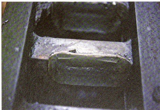
Bei der Riggenbach-Zahnstange konnten sich die Zähne hohl abnutzen, was zum Abrunden der Zahnflanken der Triebzahnräder führte. Nach Befahren mit fabrikneuen Triebzahnradern wurden diese seitlich überlastet, was zu Ausbrüchen führte.
