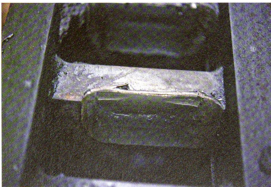
Bei der Riggenbach-Zahnstange konnten sich die Zähne hohl abnützen, was zum Abrunden der Zahnflanken der Triebzahnräder führte. Nach Befahren mit fabrikneuen Triebzahnradern wurden diese seitlich überlastet, was zu Ausbrüchen führte. (Foto: Peter Berger)
