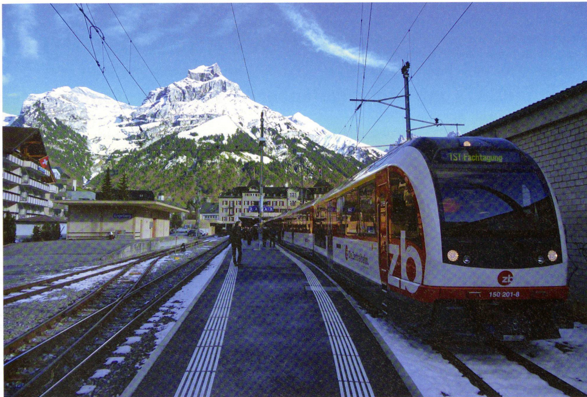
Neuer Triebzug der Zentralbahn in Engelberg. Im siebenteiligen Zug sind vier Triebzahnräder und acht Adhäsionstriebbradsätze vorhanden.
