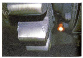
Bei der Riggenbach-Zahnstange konnten sich die Zähne hohl abnützen, was zum Abrunden der Zahnflanken der Triebzahnräder führte. Nach Befahren mit fabrikneuen Triebzahnrädern wurden diese seitlich überlastet, was zu Ausbrüchen führte.
