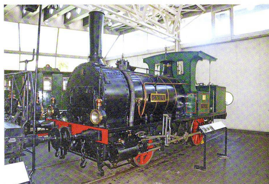
Von Riggenschbach gebaute Lokomotive für die Steinbruchbahn bei Ostermundigen.
