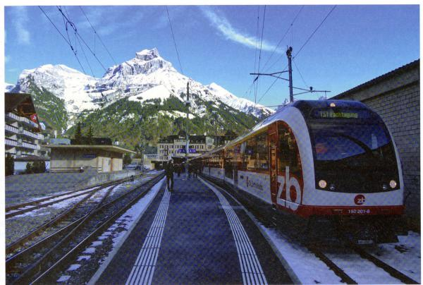
Neuer Triebzug der Zentralbahn in Engelberg. Im siebenteiligen Zug sind vier Triebzahnräder und acht Adhäsionstriebradsätze vorhanden.
