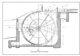
Längsschnitt einer Konstruktionszeichnung eines vollständig aus Eisenblech gefertigten oberschlächtigen Zellenrades (1900), das bevorzugt an Flussläufen mit höherem Gefälle (4–5 m), «massigen» Wassermengen, starker Verunreinigung und Grundeisbildung eingesetzt wurde. Das Wasser fliesst von einem Gerinne in die wasserdichten Zellen des Rades, die Gewichtskraft des Aufschlagwassers setzt das Wasserrad in Bewegung.
