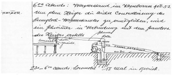
Skizze der Installation von Dampfmaschine und Zentrifugalpumpe im «Bautagebuch» von Gustav Kruck, April 1899.
