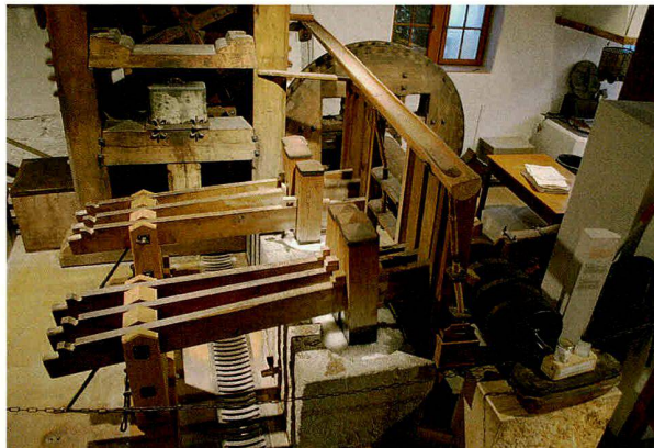
Lumpenstampfwerk in der Basler Papiermühle.
