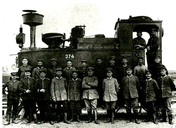
Typische «Brigadelokomotive» der kaiserlichen Feldbahn Thorn-Racionz im Ersten Weltkrieg mit aufgewickelter «Elevatorschlauch» um den Kesseldom.
