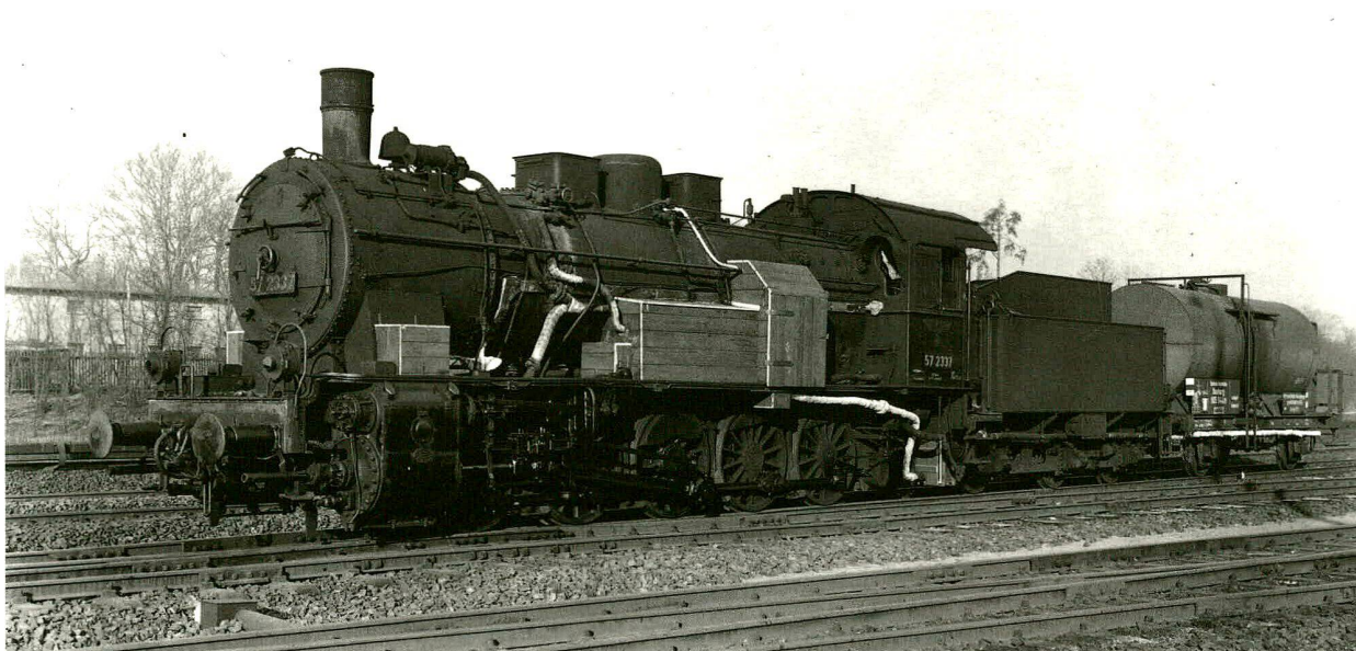
Versuche der Deutschen Reichsbahn mit einem zusätzlichen Wasserwagen und Frostschutzeinrichtungen an einer Lokomotive zum Einsatz in Russland, 1941/42.
