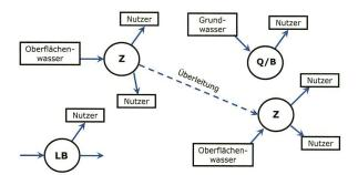
Schematische Skizze des semizentralen Wasserversorgungssystems der 2. und folgender Phasen spätestens ab der Mitte des 1. Jahrhunderts v. Chr.
