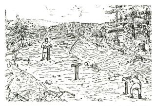
Von zwei Ausgangspunkten ausgehend, wurde die Gefällelinie einer Wasserleitung der geplanten Trasse folgend verlängert. Dabei bewegte man sich allerdings auf der Tangente der Erdkrümmung.
