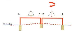
Beim Streckennivellement musste der Chorobat nach jedem Messgang gewendet werden, z.B. um Gerätefehler zu eliminieren.
