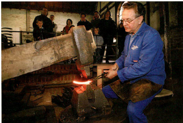
Die Herstellung einer Sense im Sensenhammer.
