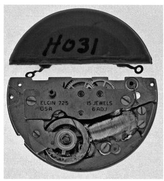
Bild 3: Das elektromechanische Elgin-Kaliber 725. (Foto: H. R. Bramaz)
